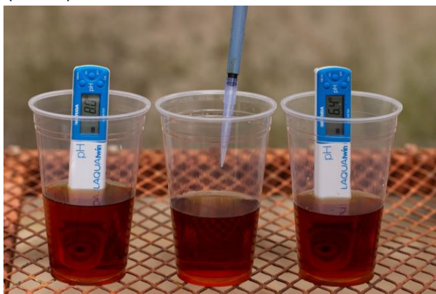
Figura 12. Mediciones de pH y CE de agua de riego antes y después de agregar fertilizantes urea, MAP y \text{KSO}_4 .
