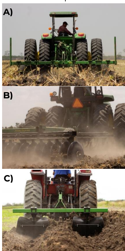
Figura 19. Preparación del suelo, subsuelo (A), rastra, cruza (B) y bordeado (C).
